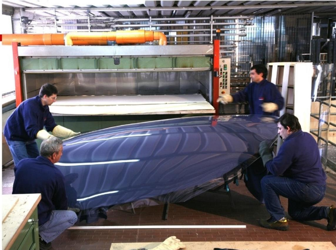
Realizzazione di un parabrezza per la nautica tramite modellazione delle lastre riscaldate in forno
